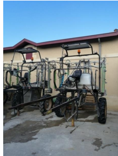
Image 10 : attelage pulvérisateur conçu par l'exploitant 2.
